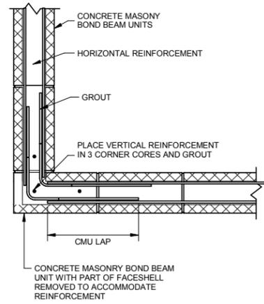
2 BOND BEAM AT CORNER DETAIL
