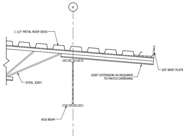
4 TYPICAL JOIST BEARING DETAIL
