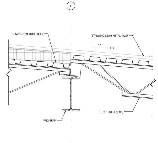
3 TYPICAL JOIST BEARING DETAIL
