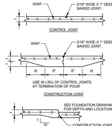
CONSTRUCTION JOINT @ DEPRESSED SLAB
