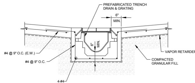
6 TYPICAL TRENCH DRAIN SECTION
