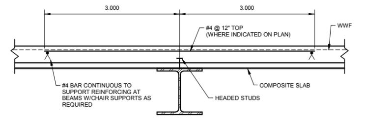
6 TYPICAL REINFORCED COMPOSITE SLAB DETAILS
