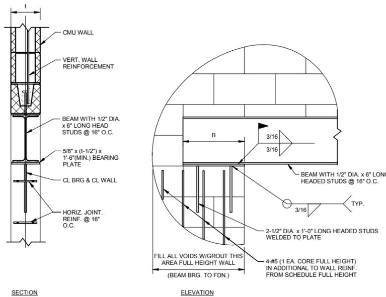
5 TYPICAL STEEL BEAM BEARING ON PARALLEL CMU WALL DETAIL
