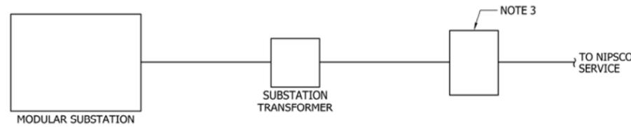
**1** SUBSTATION SINGLE LINE DIAGRAM
