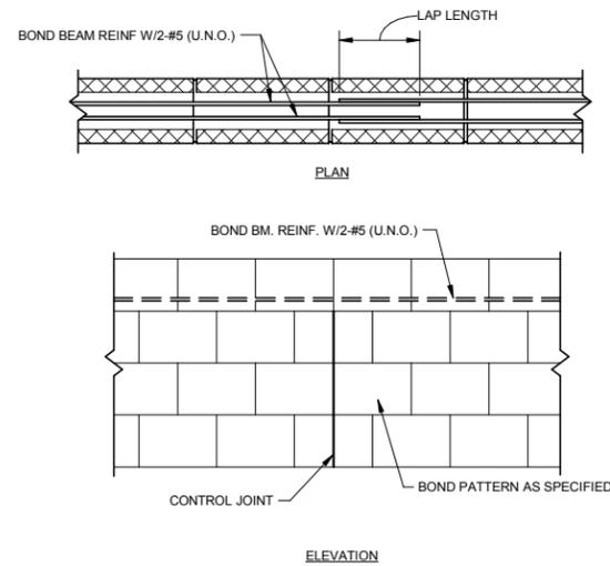
3 BOND BEAM AT CONTROL JOINT DETAIL
